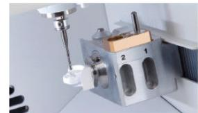
La fresatrice può essere configurata con cambio automatico a 2 o a 4 frese e con porta pin a 4 alloggiamenti per una produzione di serie, produttiva ed automatica.
